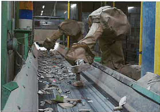
東急建設と共同開発した廃棄物選別ロボットも導入
