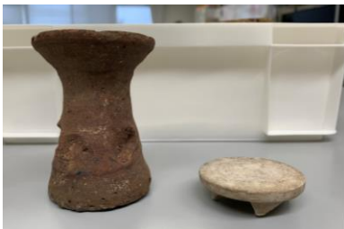
左：チャツ（耐火粘土製） 右：高台付きハマ（磁土製） （現在平佐西コミセンで保管）
