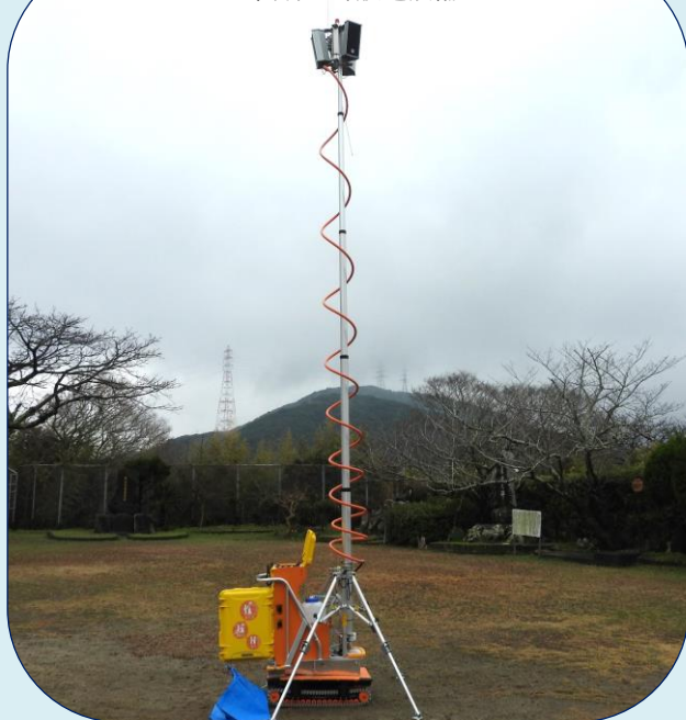
簡易屋外放送設備
